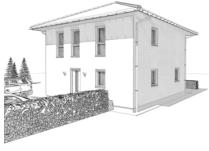
Walmdach 25°, Vollgeschoß Gebäudehöhe 6,39 m Traufenhöhe 5,90 m Firsthöhe 8,39 m ab Oberkante Fundament - 18,5cm FB-Aufbau
